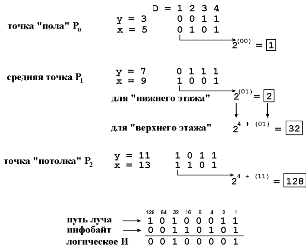
Рисунок 4: Двоичные вычисления при поиске пересеченных подбоксов
